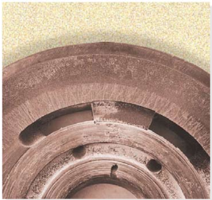
Resultados típicos de desgaste de la bomba debido a contaminación por partículas y agua.
