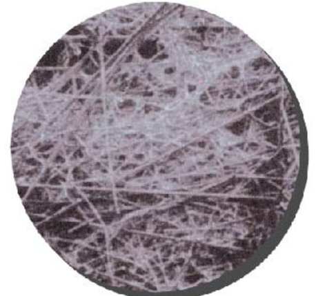
Construcción típica de fibra de vidrio fina (100X)
